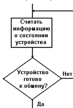
Рис. 3.10. Цикл программного ожидания готовности внешнего устройства
