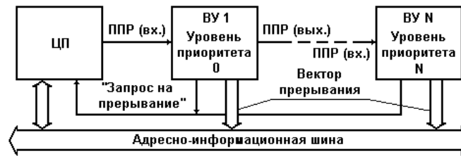
Рис. 3.14. Реализация приоритетов ВУ в микроЭВМ с векторной системой прерываний с интерфейсным вектором (ППР (вх.) - "Предоставление прерывания (входной)"; "ППР (вых.) - Предоставление прерывания (выходной)")
